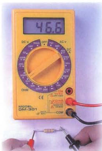
Figura 6.9. Prueba de las resistencias con el multímetro
